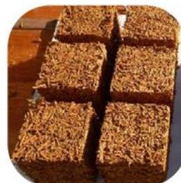
Le chanvre peut être utilisé sous différents conditionnements : la chènevotte pour le vrac, la laine de chanvre pour les panneaux, le béton préfabriqué, le béton projeté et les enduits. Ce matériau est aujourd'hui principalement utilisé pour des travaux d'isolation ou le revêtement intérieur ou extérieur de façades.
