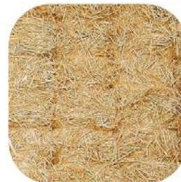
La paille est principalement valorisée dans l'isolation des bâtiments, sous la forme de bottes de paille (remplissage d'ossatures porteuses), panneaux ou d'un enduit terre/paille. La paille peut également être utilisée comme structure porteuse. Il convient de noter que les gisements de paille en France sont suffisants pour que son utilisation en construction n'entre pas en concurrence avec les besoins des filières agricoles et de l'élevage.
