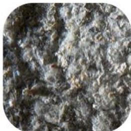
La ouate de cellulose est un matériau isolant pouvant être conditionné sous forme de panneaux, de rouleaux ou de vrac pour un usage en construction. Elle est composée à 85% de produits biosourcés (journaux ou cartons recyclés défibrés). À ces matières s'ajoutent, pour 5 à 10%, des adjuvants.
