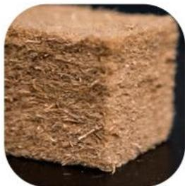
La fibre de bois, faisant partie des produits connexes du bois, peut être utilisée en laine ou en vrac en tant que produit d'isolation ou mélangée à des ciments pour former des bétons.
