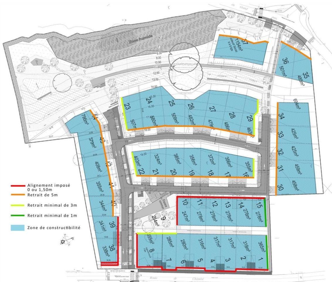
Schéma d'implantation des constructions
